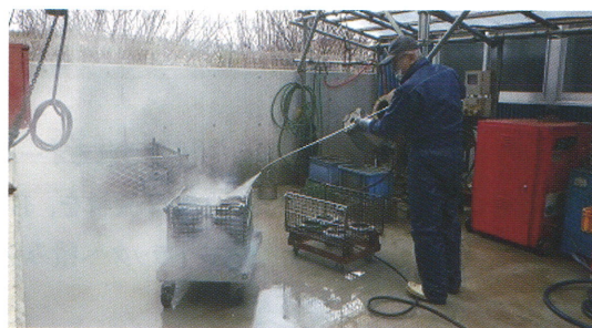
写真-39 ビクトリックジョイントの洗浄
