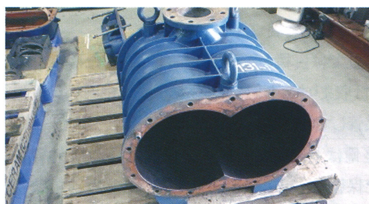
写真-29 排泥ユニット真空ポンプ分解(3)
