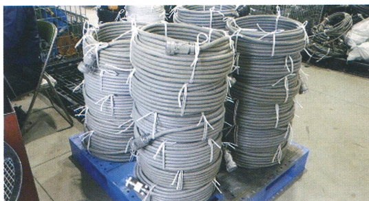
写真－41 線巻機で巻いた電線
