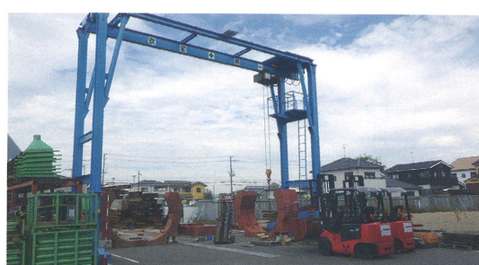
写真－20 C・D棟前の2.9t吊り橋型クレーン
